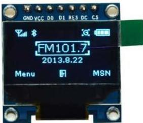
图 2.5 OLED 模块实物图片
