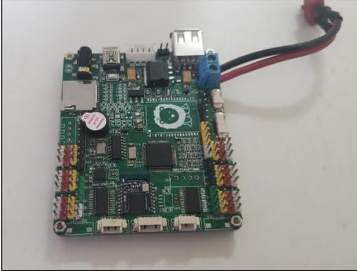
图 2.16 本文设计的机器人控制器实物图片
