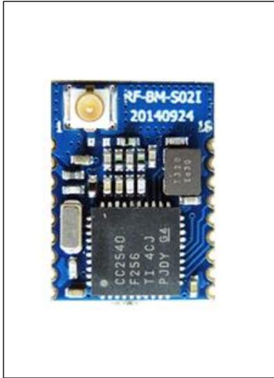
图 2.3 RF-BM-S02I 蓝牙模块实物图片
